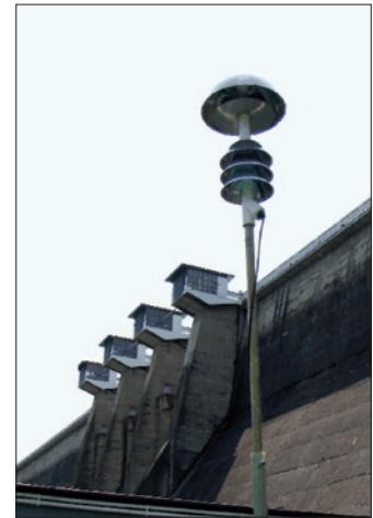
Fot. 1. Czujnik pola elektrostatycznego na budynku elektrowni w Solinie
